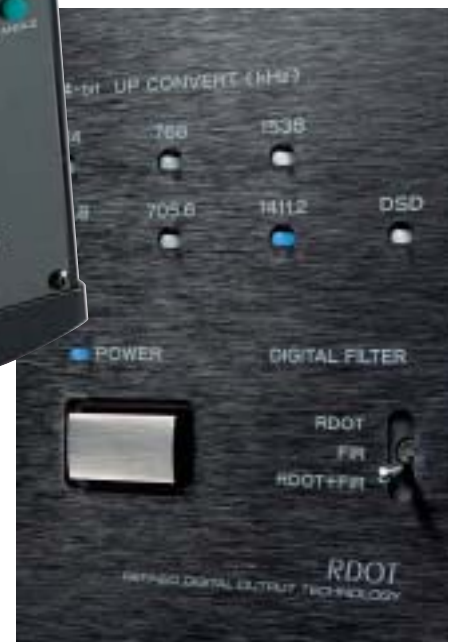
Upsampling am Limit: Je nach gewähltem Filter und eingelegtem Medium rechnet der DV-50 bis auf über 1,5 Megahertz Datenrate hoch
