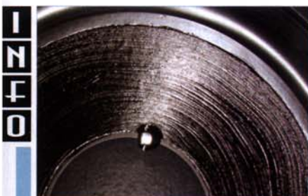
ACT-Bass: Ein Mini-Mikrofon dient dem geregelten System als Sensor für die Kontrolle des Membranhubs.
