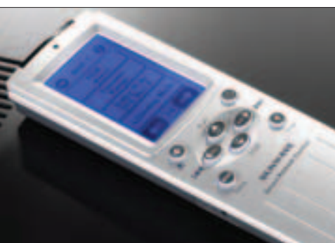
Praktisch: Die Touchscreen-Fernbedienung geriet zwar nicht edel, aber sehr funktionell. Per USB-Adapter (unten) lässt sie sich am PC programmieren.
