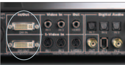
Platz sparend: Rein und raus geht's für Komponenten-Signale nur über DVI-I-Buchsen (Oval). Multipin auch beim analogen 7.1-Eingang (großes Bild, Pfeil).
